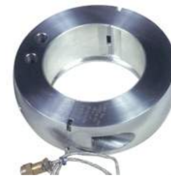
ITEM : L.P. BEARING DIM' : O.D317 X I.D228 X B141 MAT'L : B21A14/SM400B
