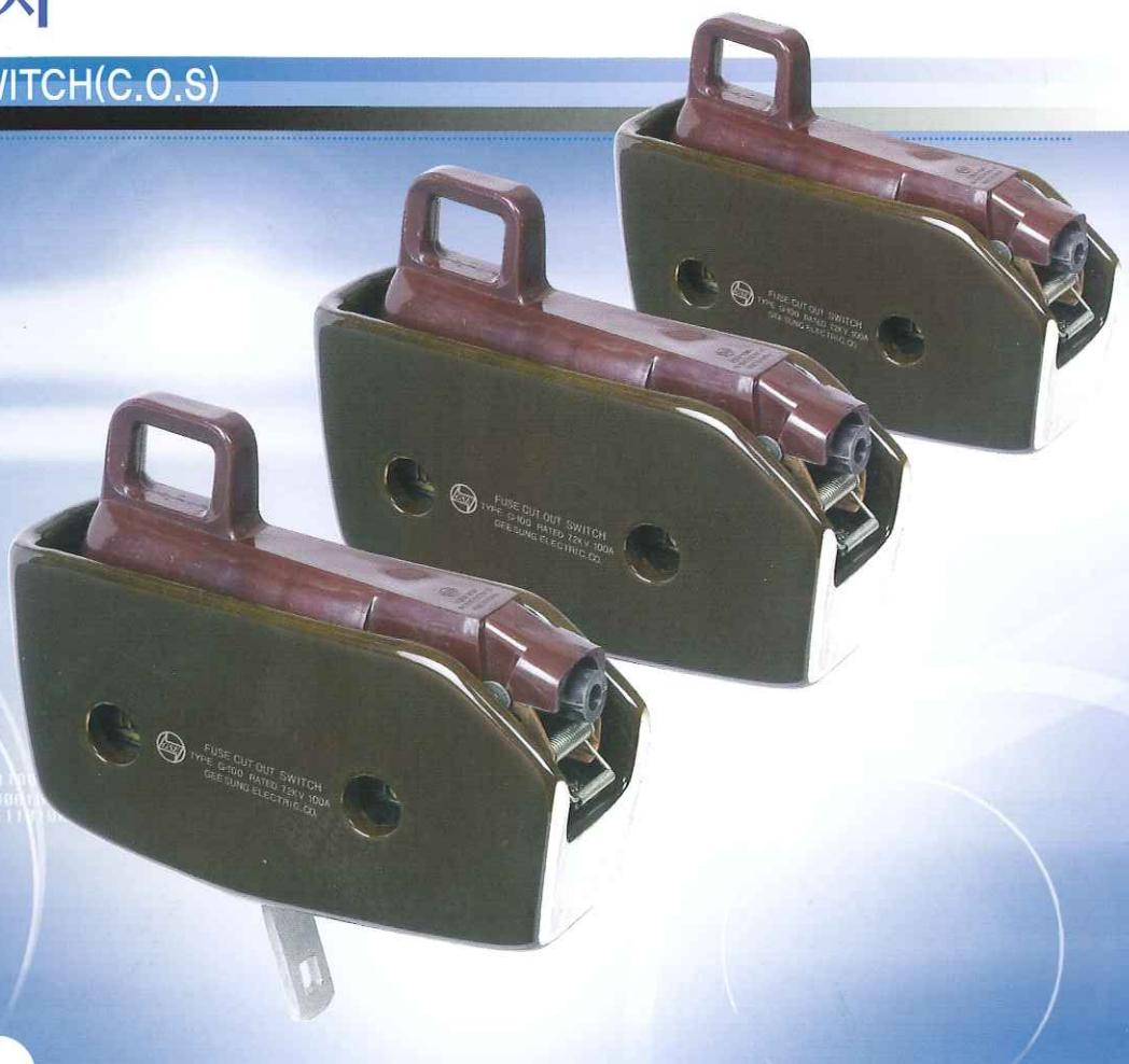
7.2kV 100A COS는 선로전압이 3,300V, 6,600V의 △(델타)선로에 적용되며, 최대 전류 용량이 100A로서 구 변전선로 및 철도, 특수용도 선로에 사용됩니다.
